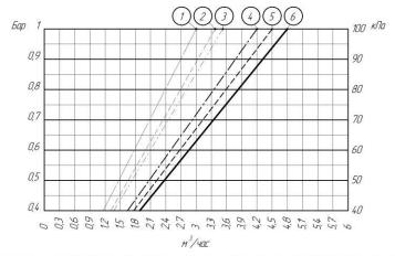
Рисунок 1 – Диаграмма расходных показателей клапана регулирующего устройства
