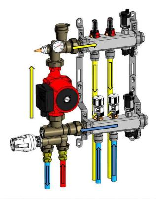
Рисунок 9 — Схема распределения потоков жидкости в коллекторной системе в сборе (красный – горячая вода с бойлера (котла); желтый – теплая вода, подающаяся в систему теплого пола; синий – холодная вода, выходящая из петель теплого пола)
